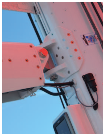
Special gooseneck on a furling mast Vit de mulet spécial sur mât enrouleur
