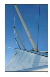
Les mâts enrouleurs manuels SPARCRAFT - Gamme E - utilisent des systèmes éprouvés d'enroulement à vis sans fin. Ce système permet de réduire ou rouler, seul, entièrement la Grand Voile du cockpit de façon fiable grâce à un guidage parfait de la commande d'enroulement. Sparcraft propose aussi des assistances hydrauliques ou électriques pour un plus grand confort d'utilisation.
