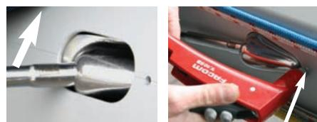
*fixation d'un rivet de sécurité*
