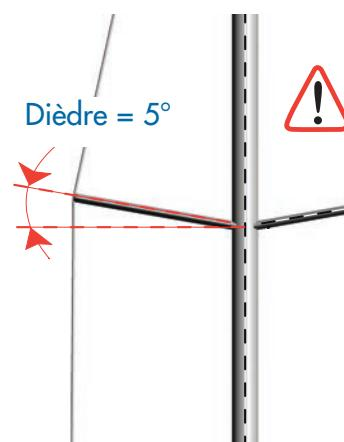
**Nota :** utilisation éventuelle d'un serre-joint de compression pour montage BDF sur barreau inox : selon la procédure jointe à ces barres de flèche.
