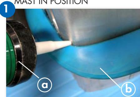
Une fois le mât en position, et avant d'installer la jupe d'étambrai, étancher l'extérieur du mât en réalisant un cordon de Sika (a) à l'intérieur du chanfrein de la cale d'Etambrai (b)
