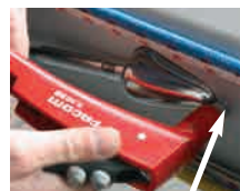
fixation d'un rivet de sécurité
